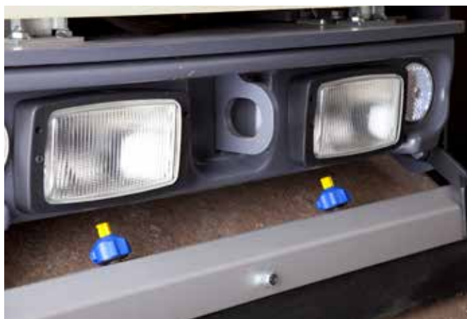
Sistema de aspersão pressurizado com uma poderosa bomba de água com tubos e bocais de aspersão com sistema de autodrenagem.
