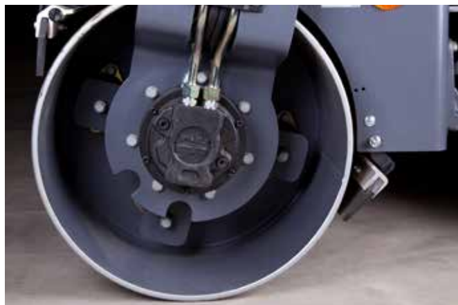
Rolo de grande diâmetro facilita a compactação mesmo com misturas asfálticas macias. Cilindros possuem grande espessura, proporcionam alta durabilidade.
