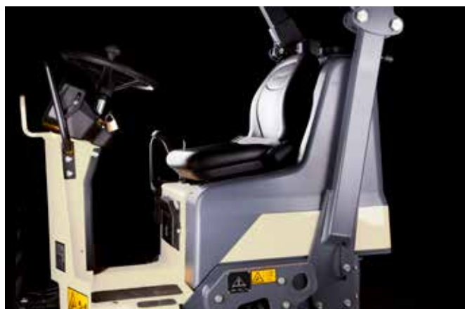
Espaçosa plataforma do operador com amortecimento de vibrações com assento confortável e alavancas de avanço/recuo duplas opcionais para total conforto do operador,
