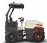
O Dynapac CC1300C VI é um rolo compactador projetado para atender às exigências rigorosas da indústria da construção, focando no conforto do operador. Este modelo de sexta geração apresenta um motor montado transversalmente que proporciona excelente visibilidade e um design robusto.
