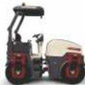
O Dynapac CC1300 VI é um rolo compactador tandem vibratório projetado para diversas aplicações em compactação de solos e asfaltos, desde pequenos reparos até grandes obras, como construção de estradas e aeroportos.
